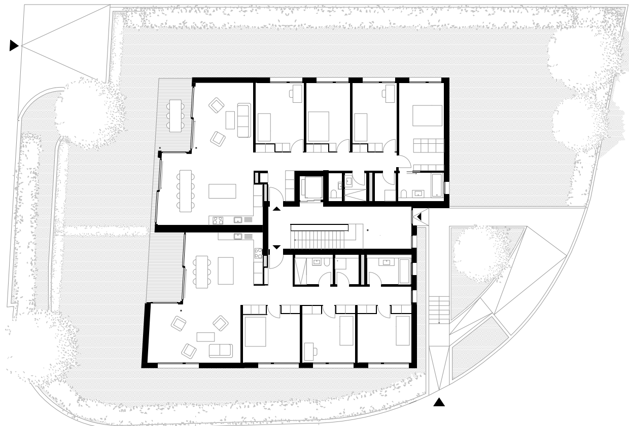
Plan du rez-de-chaussée avec un appartement de 4,5 pièces et un de 5,5 pièces.
