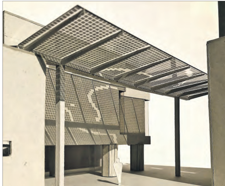
Modellfoto des geplanten Glasdachs mit Photovoltaik-Anlage.
